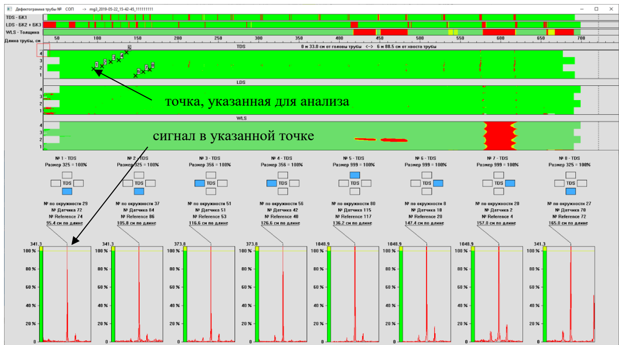
Рисунок 15 – Дефектограмма СОП и сигналы в указанных точках, выведенные на один экран для анализа
